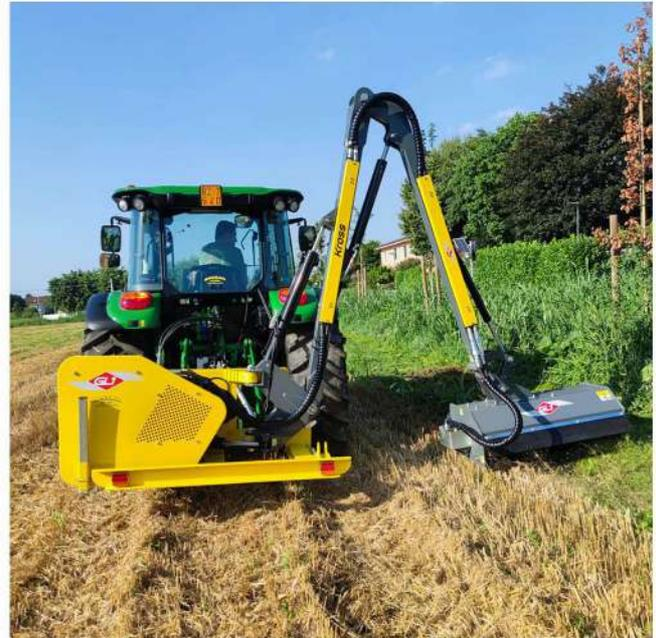
Манипуляторный мульчеровщик – кусторез для использования совместно с тракторами моделей от МТЗ 82. Отлично подходит для выполнения расчистных работ вдоль дорог, кюветов. Рабочая ширина кошения составляет 120 см. Эффективная и надежная гидравлическая система предназначена для постоянных нагрузок, для использования в профессиональной сфере обслуживания придорожных территорий.
