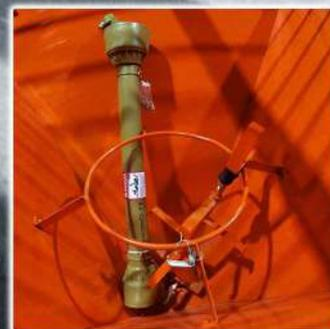
Бункер, рама навески, навеска на трактор МТЗ, редуктор привода, тарелка с лопастями, сменные лопасти, дистанционная тяга, фракционная решетка, вал карданный.
